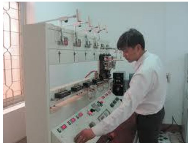
KIỂM ĐỊNH CÔNG TƠ ĐIỆN
